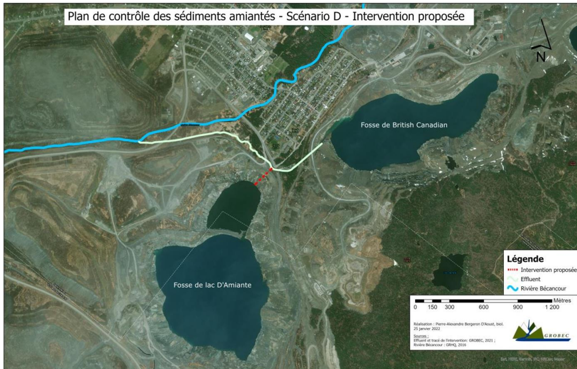
Figure 28 Canal (pointillé rouge) proposé pour connecter la fosse de British Canadian à la fosse de lac d'Amiante afin d'accélérer l'envoiment de celle-ci.
