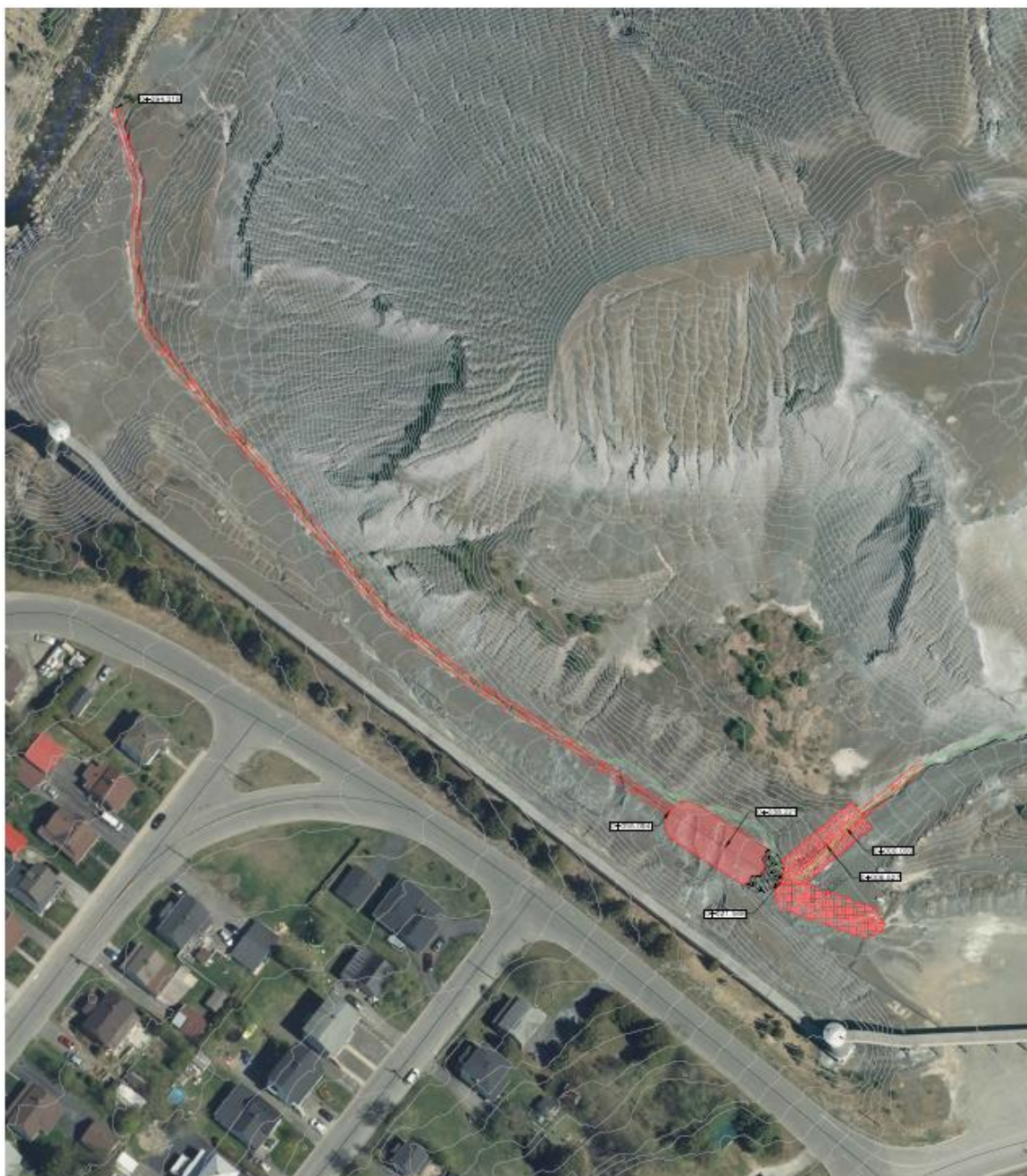
Figure 23 Plan du bassin de sédimentation proposé pour capter les sédiments d'un écoulement préférentiel à la mine British Canadian. Source : Service d'ingénierie, Ville de Thetford Mines.
