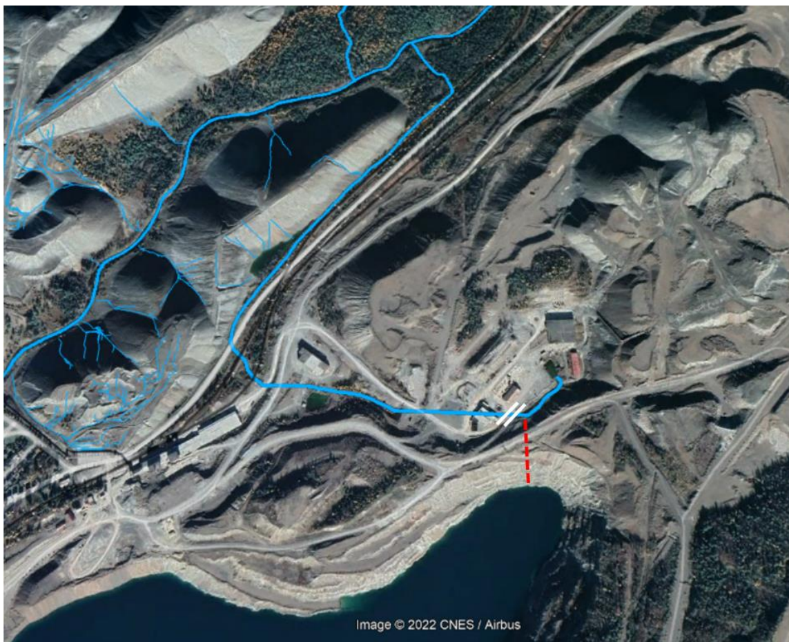
Figure 25 Canal (pointillé rouge) proposé pour détourner le ruisseau vers la fosse de la mine British Canadian.
