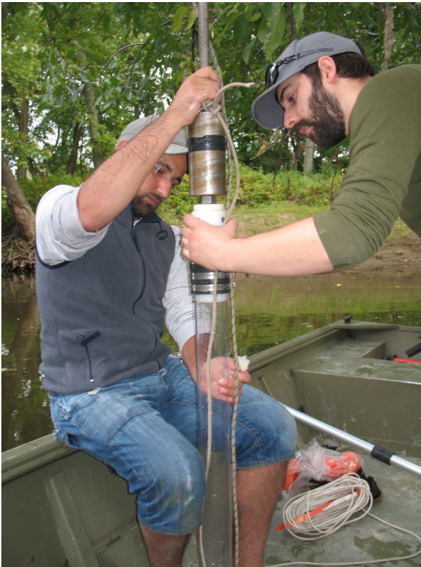
Figure 4.2. Photographie d'un carottier à percussion muni d'un tube d'échantillonnage, tel qu'utilisé lors des travaux de terrain. La percussion (poids de couleur bronze) est utilisée comme marteau afin d'enfoncer le tube dans les sédiments.
